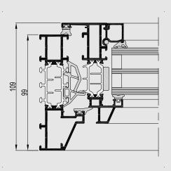
SlimLine 38 è un sistema ad elevato isolamento per finestre e porte ad apertura interna ed esterna, che combina eleganza e comfort con un design unico. L'aspetto sottile che ricorda quello delle finestre in acciaio è la soluzione ideale per l'architettura moderna e per la ristrutturazione di vecchie finestre con telaio in acciaio, rispettando il design originale ma offrendo una soluzione termicamente migliore.
