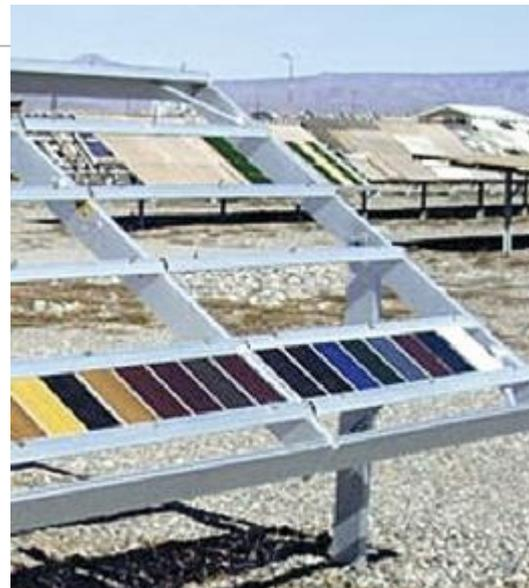
il test di resistenza agli agenti atmosferici all'aperto nel caldo soffocante dell'Arizona dimostra che la temperatura rimane al di sotto del 60°C anche nel caso di profili rivestiti con decorativi scuri
